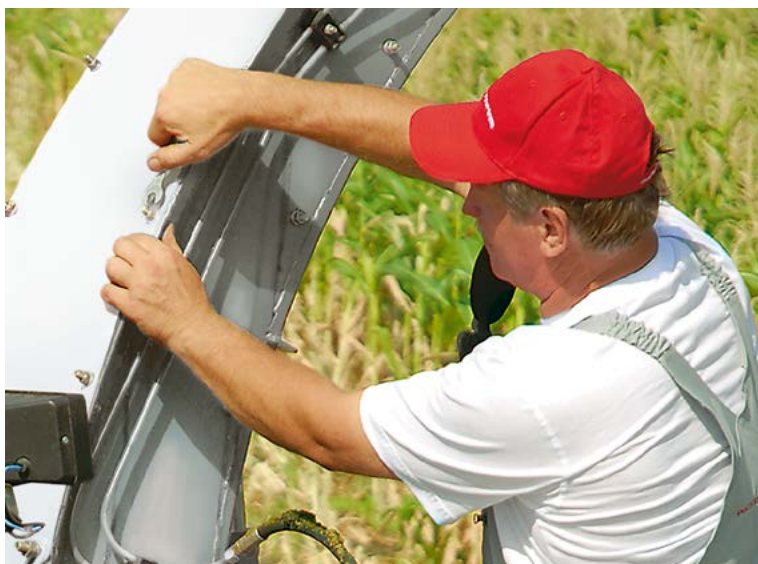
Сменные пластины силосопровода – снижение затрат на замену силосопровода
