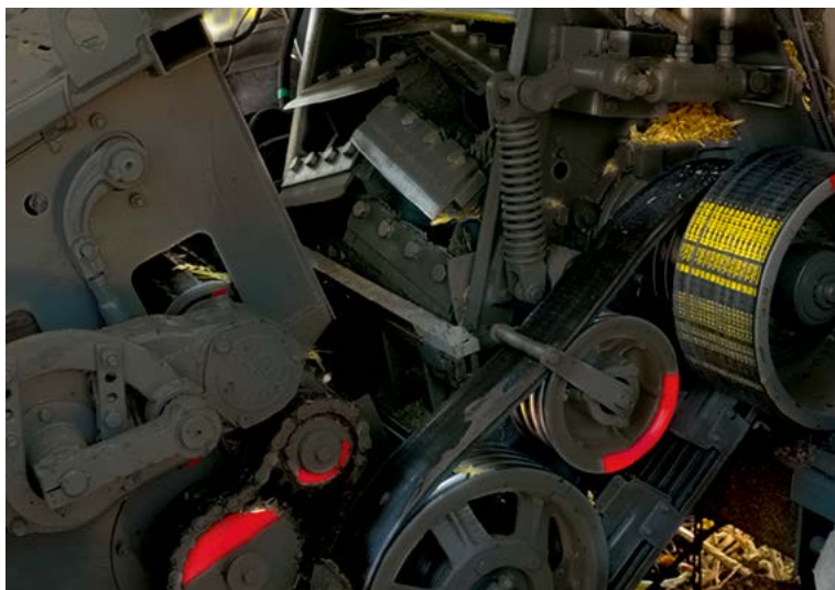
Отсоединение питателя от измельчающей камеры без демонтажа адаптера
